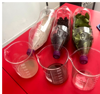
Figura 7: Maior erosão em solos sem cobertura vegetal.
