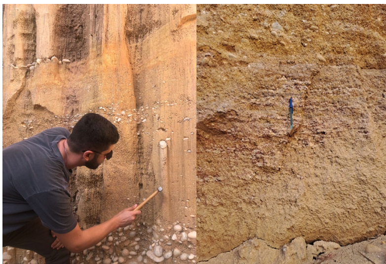
Figura 7: Coleta de amostras de sedimento para avaliação granulométrica no ambiente de Formação Barreiras selecionado para estudos.
